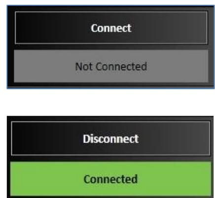
Nachdem die Aktualisierung der USB-Firmware abgeschlossen ist, verbindet sich Plasma5 CNC mit Ihrem Signalgeber. Bei einer korrekten Verbindung, wird der graue Balken grün und zeigt den Status *Connected* an. Nun ist das Werkzeug zur Verwendung bereit
